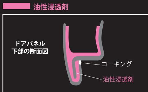
経年のドア開け閉めによって、ドア下部のヘミング部にあるコーキングに劣化、亀裂が起こり、雨水などが侵入することによって錆びを誘発します。
