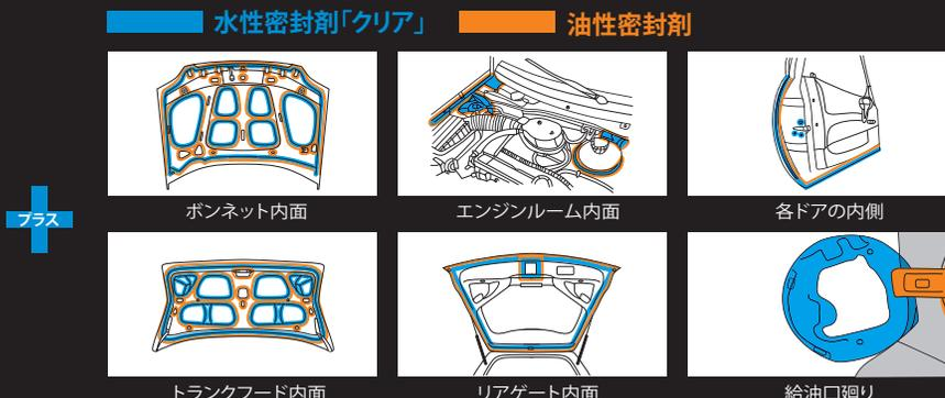
沖縄独自の【2ステップ防錆】に加え過酷な環境でも万全の対策を行えるよう、以下の箇所へ水性密封剤「クリア」を塗布し、油性密封剤を組み合わせることで、沖縄独自の【3ステップ防錆】に進化！
